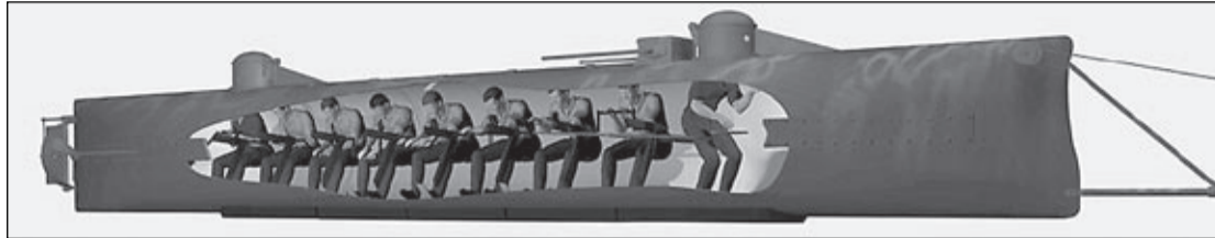
Szkic przekrojowy okrętu podwodnego „H. L. Hunley”
